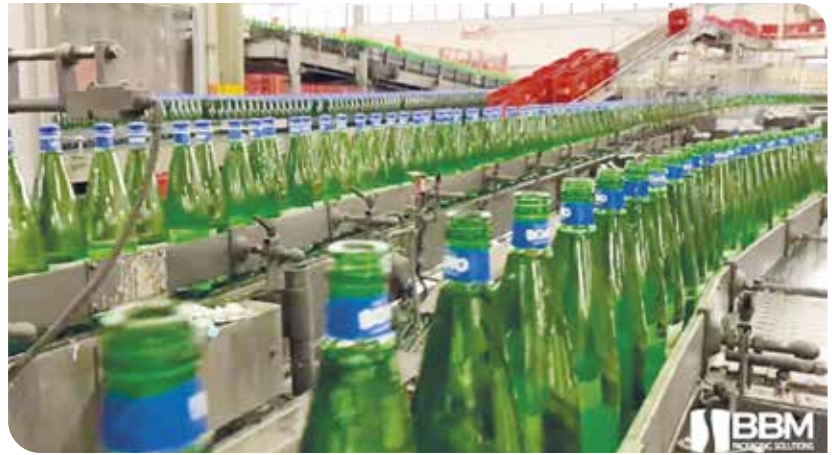
Linea BBM per imbottigliamento in vetro da 40.000 pezzi l'ora.
