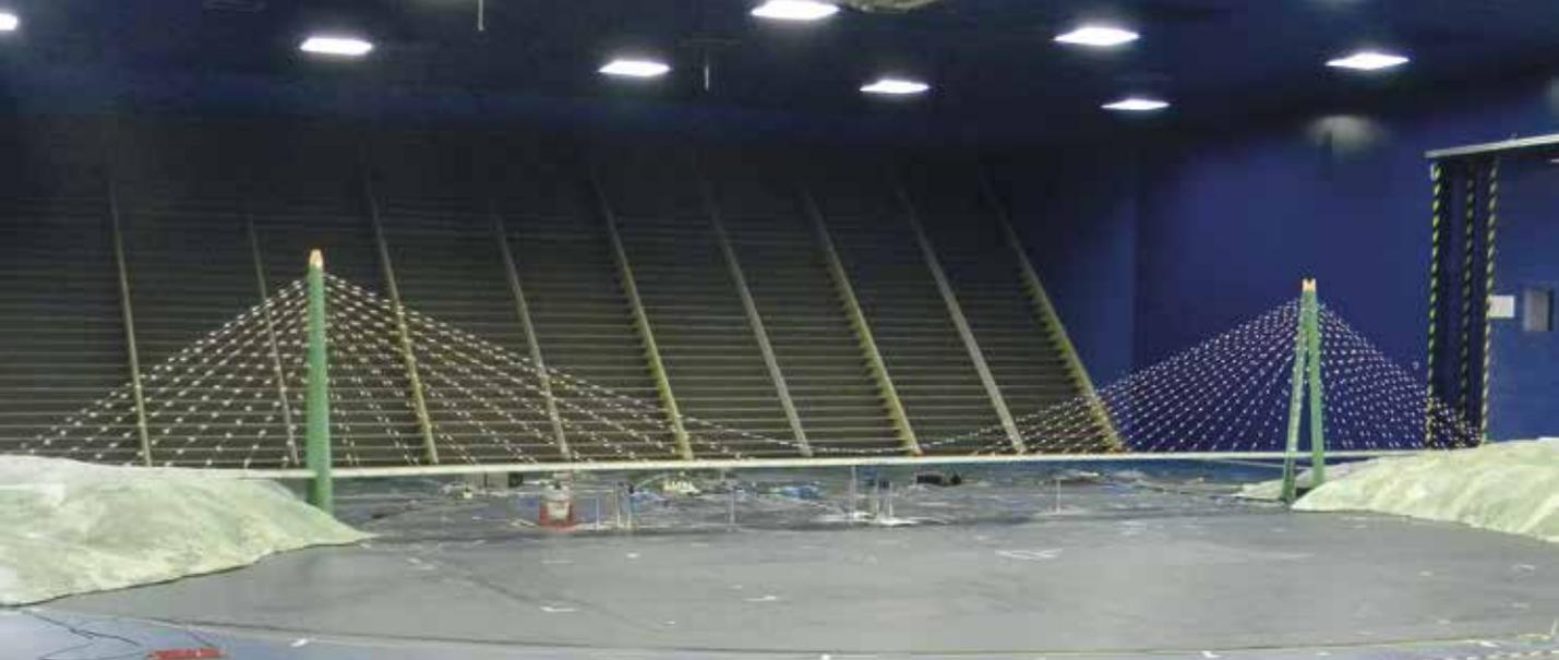
Modello aeroelastico del Ponte Yavuz Sultan Selim, terzo attraversamento permanente del Bosforo.
