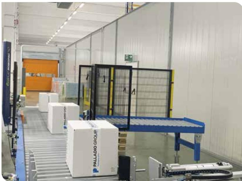
Applicatore RFID in basso a destra e, in lontananza, il varco dove tutti gli RFID del pallet vengono controllati e confrontati con l'ordine di acquisto del cliente.
