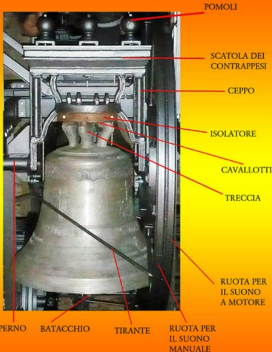
*Schema con nomenclatura delle parti di sostegno, bilanciatura e movimentazione della campana utilizzate attualmente per il suono a sistema ambrosiano.*
